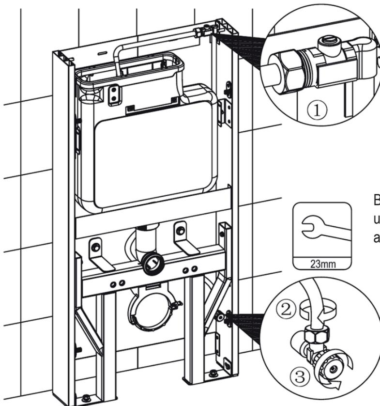
Befestigen Sie das Rohr wieder mit dem Bügel (1) und verbinden Sie unten das Rohr mit dem Eckventil an der Wand (2 + 3).
