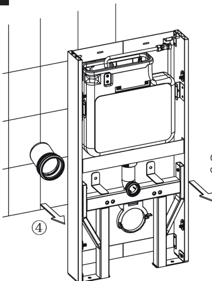
Öffnen Sie die Schelle und entfernen Sie das Sanitärmodul von der Wand (4).
