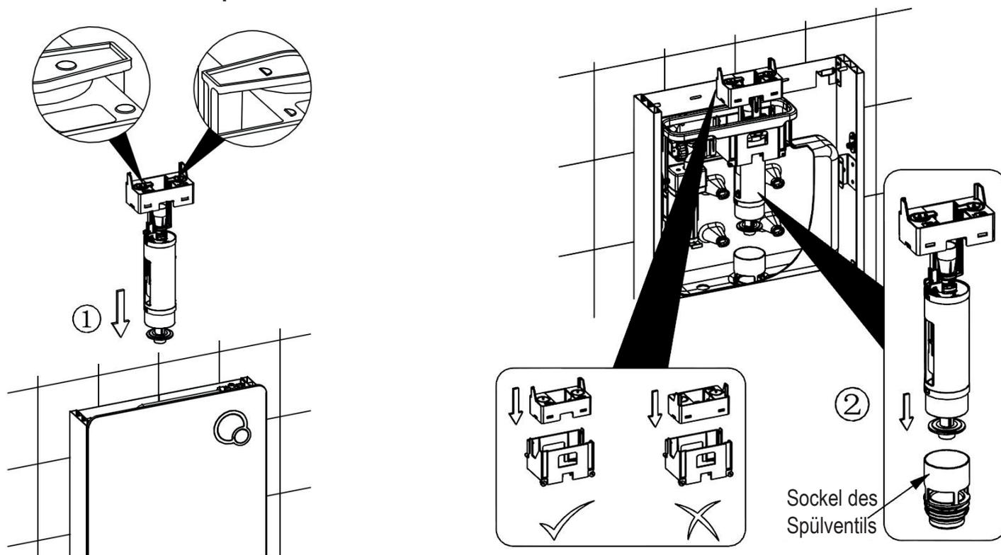
Montieren Sie das Spülventil von oben nach unten in das Sanitärmodul (1).
