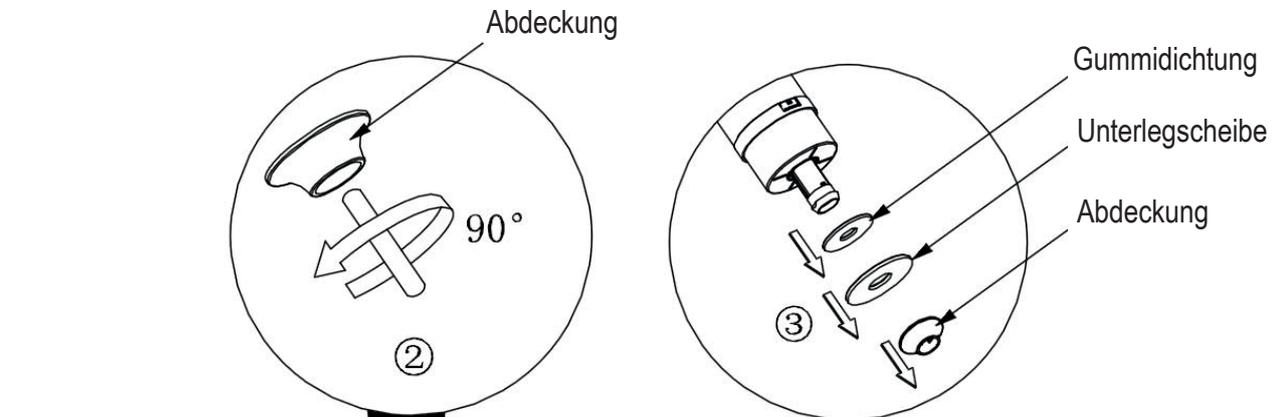
Drehen Sie die Abdeckung um 90° entgegen dem Uhrzeigersinn (2). Nehmen Sie dann Abdeckung, Unterlegscheibe und Gummidichtung ab (3).
