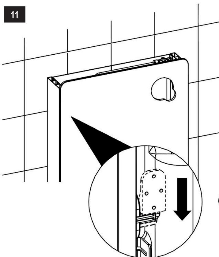
Befestigen Sie das Glaspaneel auf dem Aluminiumrahmen des Sanitärmoduls (1). Drücken Sie es nach unten (2), sodass die Halterungen des Glaspaneels in die Halterungen des Rahmens einrasten.
