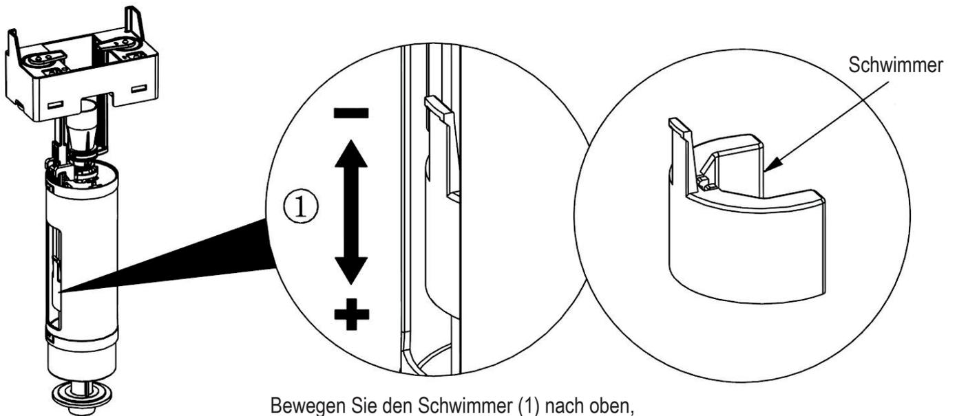
Bewegen Sie den Schwimmer (1) nach oben, um die einfließende Wassermenge zu verringern bzw. nach unten, um sie zu erhöhen.
