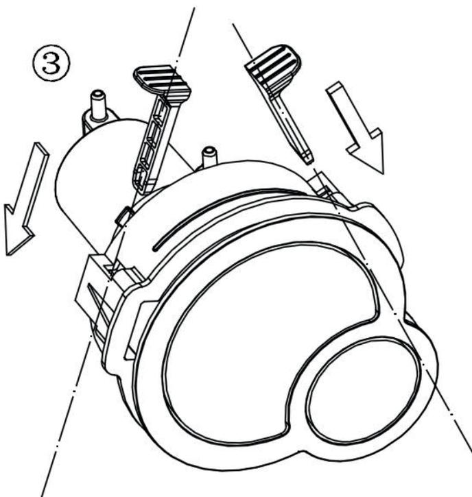
Schieben Sie nun die Arretierungen in den Halterahmen (3) um die Betätigungsplatte zu fixieren.
