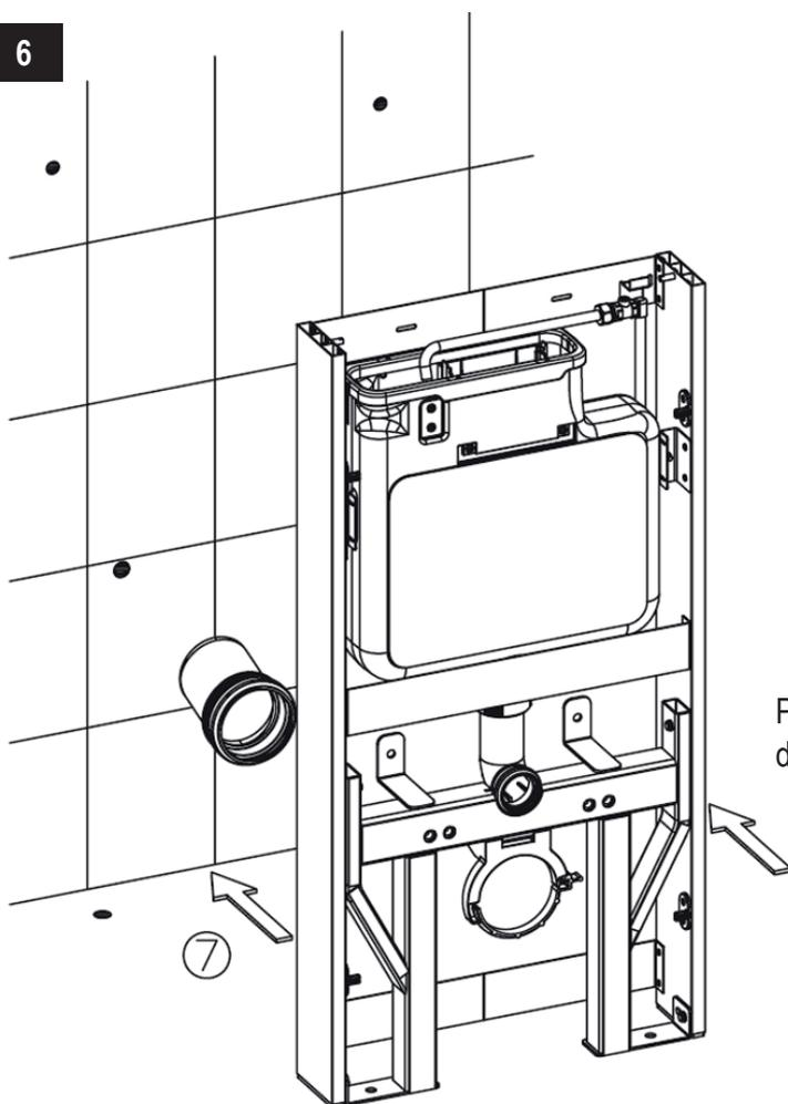
Positionieren Sie das Sanitärmodul an die korrekte Position der Wand (7).
